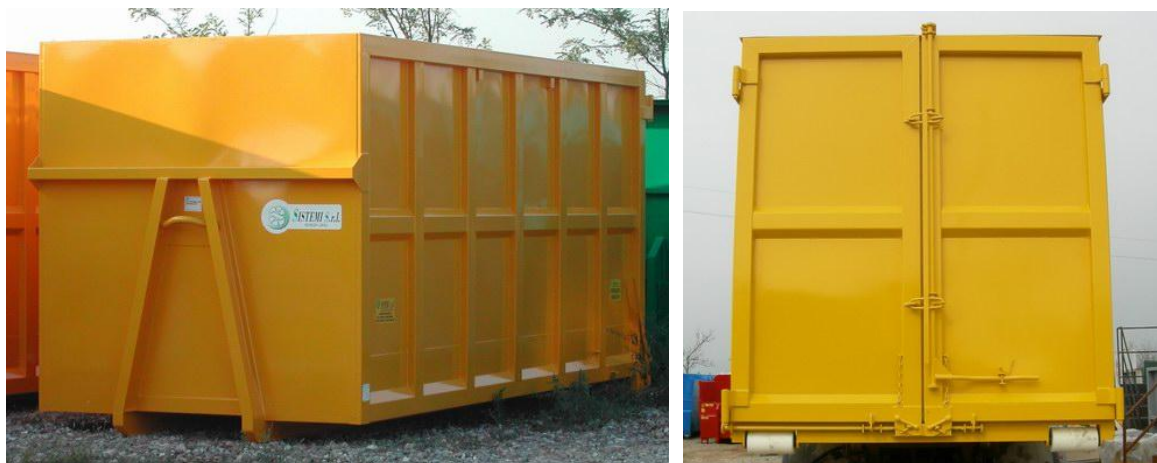
Foto 4 – Cassone scarrabile a tenuta stagna, del tipo impiegato da AIMERI AMBIENTE s.r.l. per il trasferimento dei rifiuti, con portellone anteriore.
